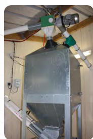
Trémie peseuse de distribution en polyester, cartérisation en acier galvanisé.
